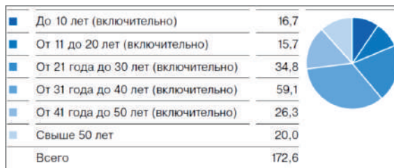
Рис. 14. Распределение протяженности магистральных газопроводов «Газпрома» на территории России по срокам эксплуатации по состоянию на 31.12.2018, тыс. км
