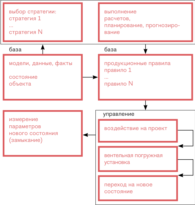
рис. 02 —> Схема интеллектуального анализа и управления отдельной насосной станцией
